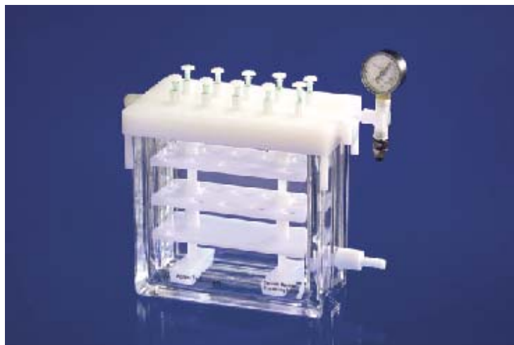
Fig.2.16. Dispozitiv de creat vacuum folosit în EFS
